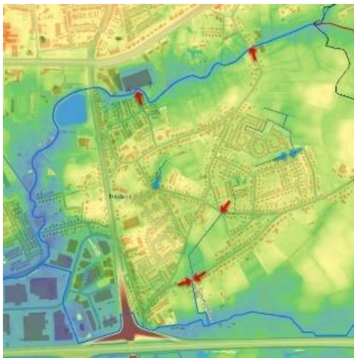
Figuur: Schorvoort, inlopen regenwater (blauwe pijl) en overstorten gemengd rioolwater (rode pijl)
