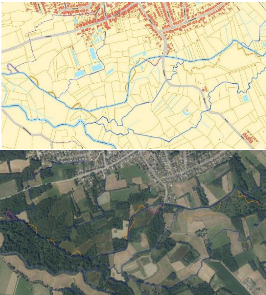
Figuur 7 De ligging van de historische meanders (GRB basiskaart (boven) en luchtbeeld (onder)) Geel = opnieuw aangesloten / paars = niet opnieuw aangesloten
