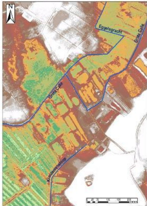
Figuur 13 Digitaal hoogtemodel Calievallei met verspreiding veenbodems
