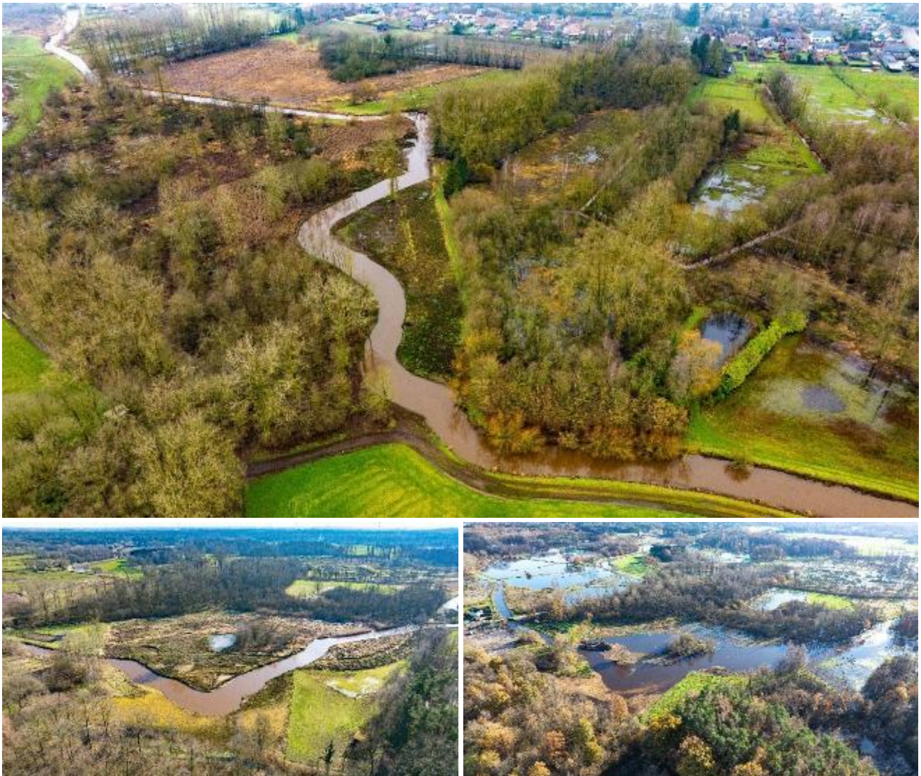
Figuur 9 Luchtbeelden van rivier Aa in Graafweide-Schupleer na uitvoering van het hermeanderingsproject, beeld rechts met waterberging.
